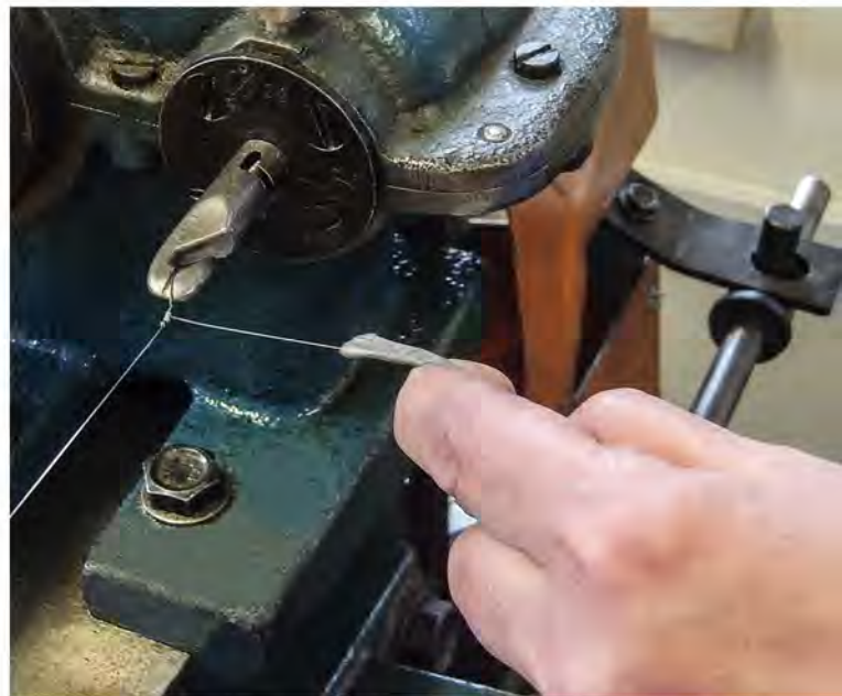
Beginn des Spinnvorganges: Umwickeln des Saitenkerns mit Draht
