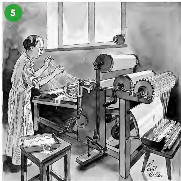
5 Entschleimen der durch Wasser erweichten Trockendärme
