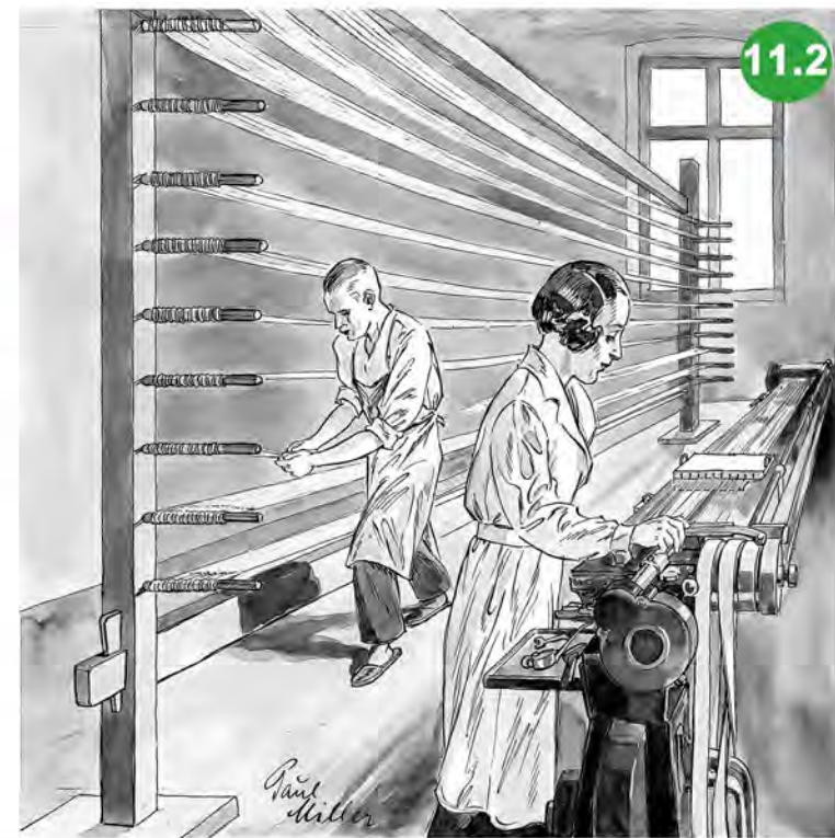
11.2 Links: Abreiben der fertig getrockneten Saiten mit Bimsstein Rechts: Quintenreinschleifen der Saiten durch Spezialmaschine
