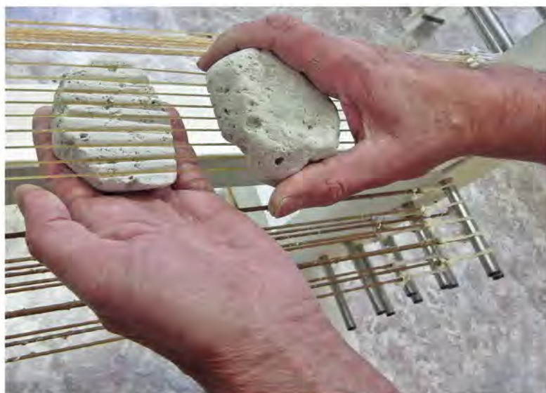
Erfassen eines oberen und unteren Bimssteines mit einer Hand bei dazwischenliegenden Saiten
