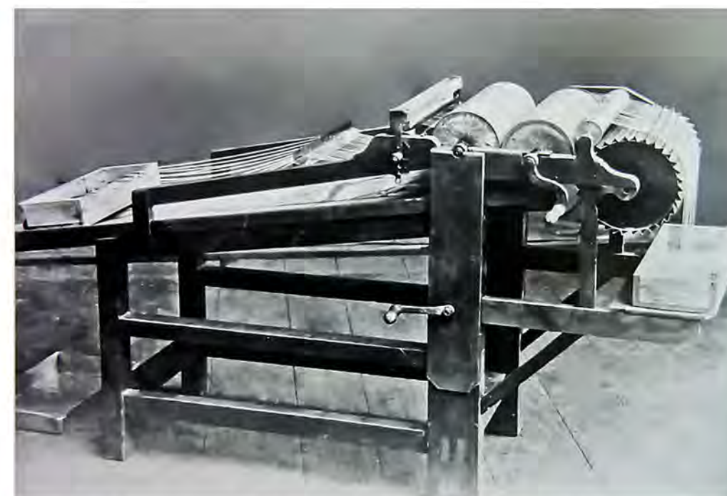
frühes Modell der Schleimmaschine (Darmreinigungsmaschine) von Seckendorf, Schreiber und Huster
