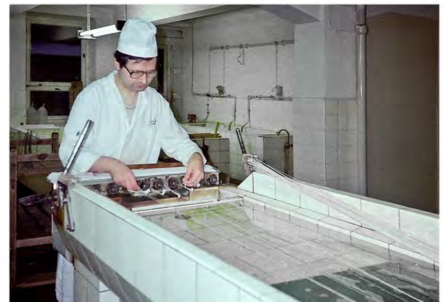
10-Spindel-Verdrillautomat für Catgut
