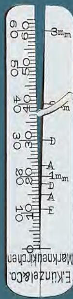
Saitenmesslehren für Harfensaiten Violinsaiten und Cellosaiten Lehre mit 1/20 mm-Skala
