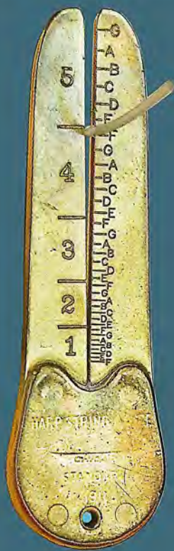
Saitenmesslehren für Harfensaiten Violinsaiten und Cellosaiten Lehre mit 1/20 mm-Skala
