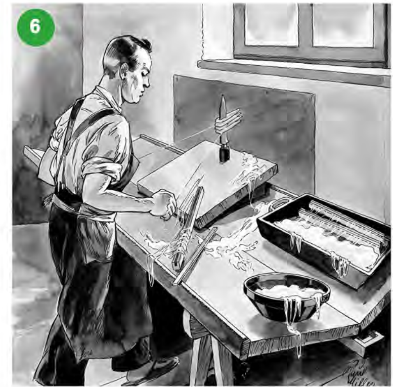
6 Durch ein haarscharfes Messer werden die gereinigten Därme in 2 Hälften gespalten
