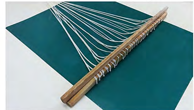
Auflegen der Darmenden und anschließendes Fixieren derselben auf einer Leiste
