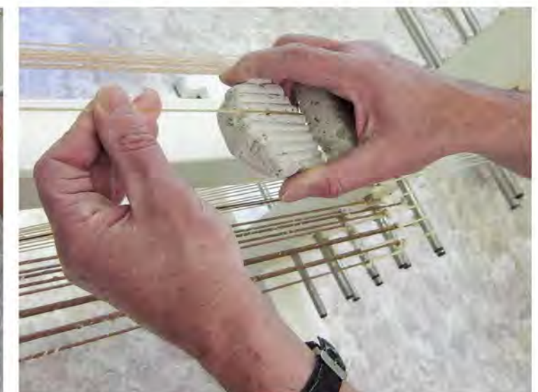
Schleifen einer einzelnen (dickeren) Saite, die dabei mit der freien Hand in beide Richtungen gedreht wird
